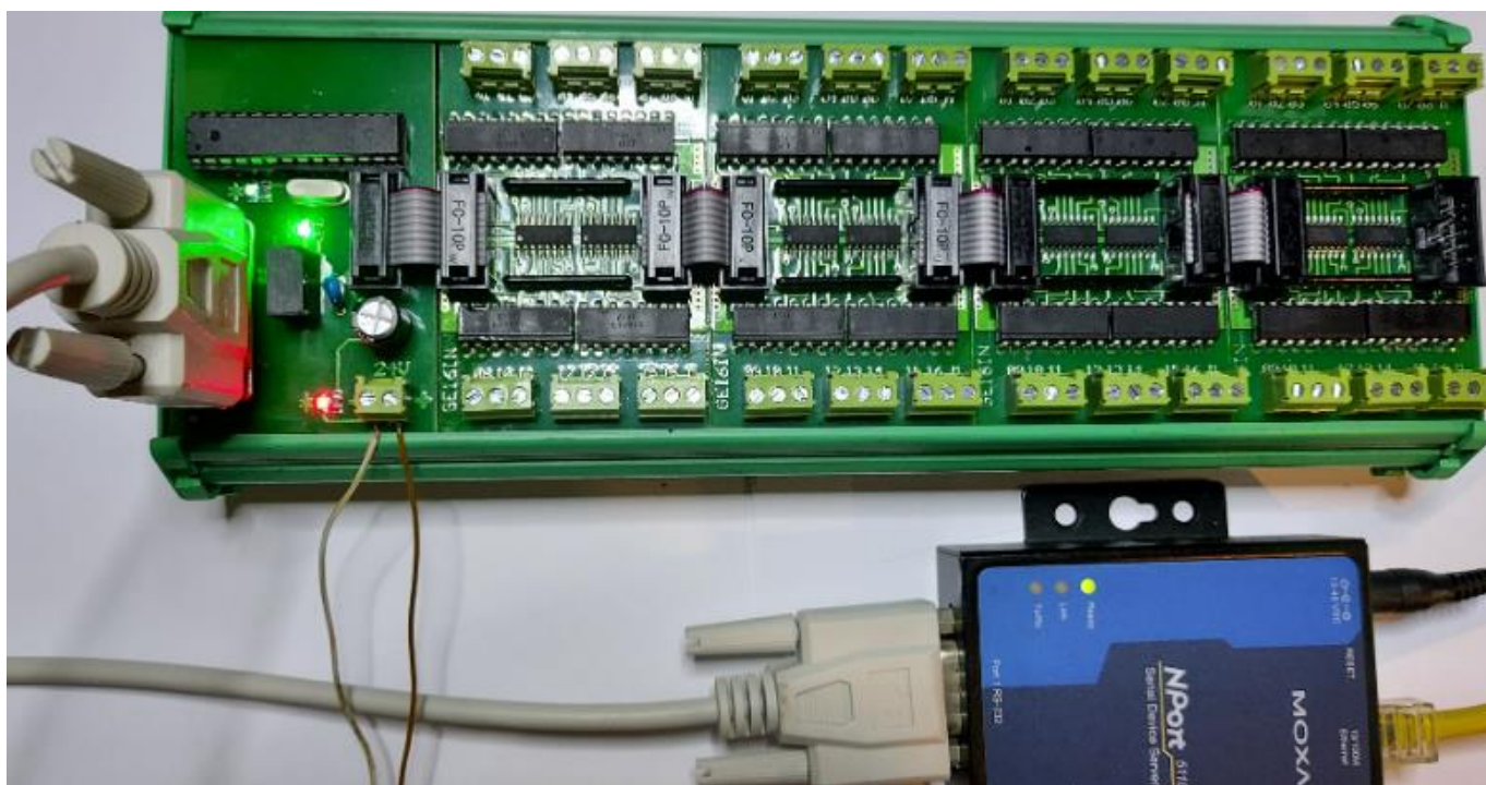
Koncentrator GK64IN. Widoczny konwerter RS/LAN Nport5110
